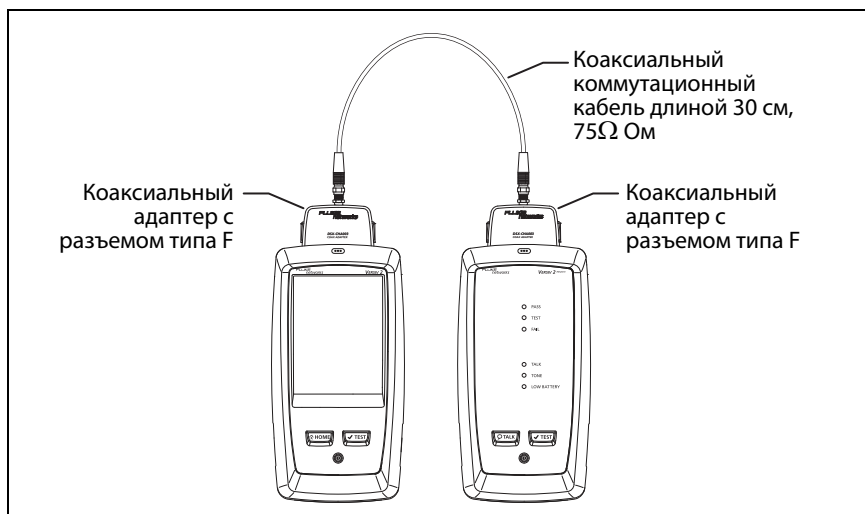
Рис. 28. Эталонные соединения для тестирования коаксиальных кабелей
