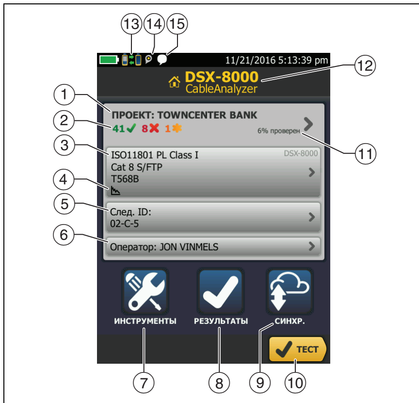
Рис. 12. Главный экран DSX CableAnalyzer
