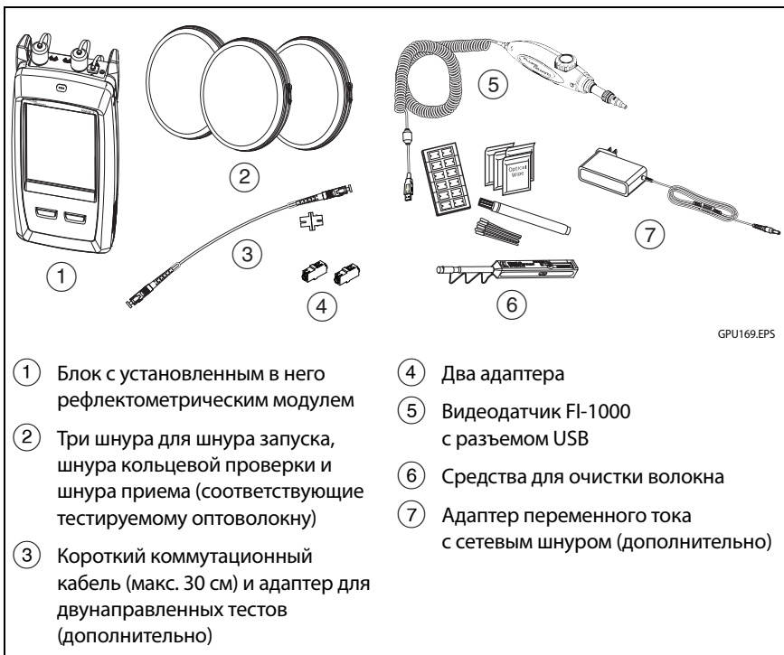
Рис. 79. Оборудование для выполнения теста SmartLoop
