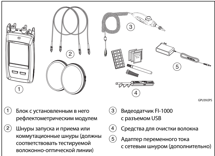
Рис. 76. Оборудование для выполнения теста FaultMap
