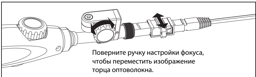
Рис. 39. Использование дополнительного наконечника для обследования MPO/MTP®
