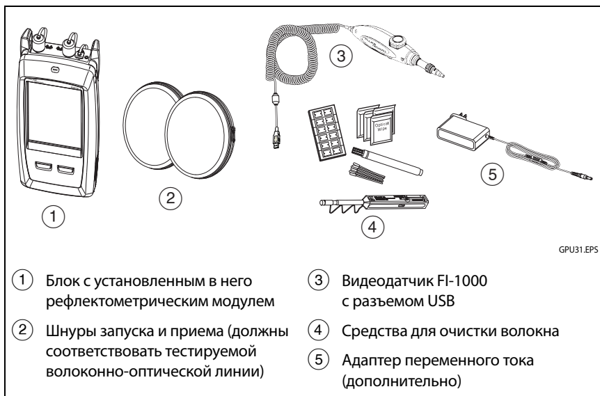
Рис. 67. Оборудование для выполнения теста рефлектометром
