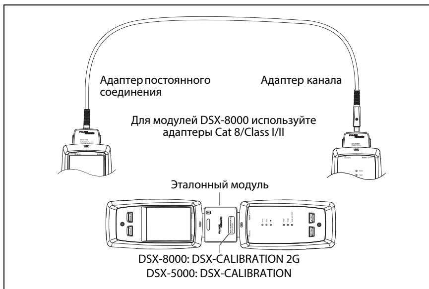
Рис. 13. Эталонные соединения для кабелей с витыми парами
