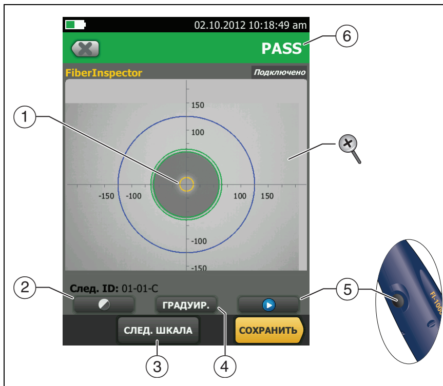
Рис. 40. Изображение FiberInspector в режиме ручного градуирования
