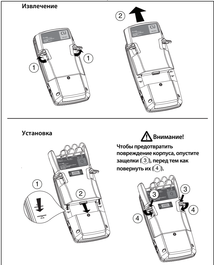
Рис. 6. Извлечение и установка модуля
