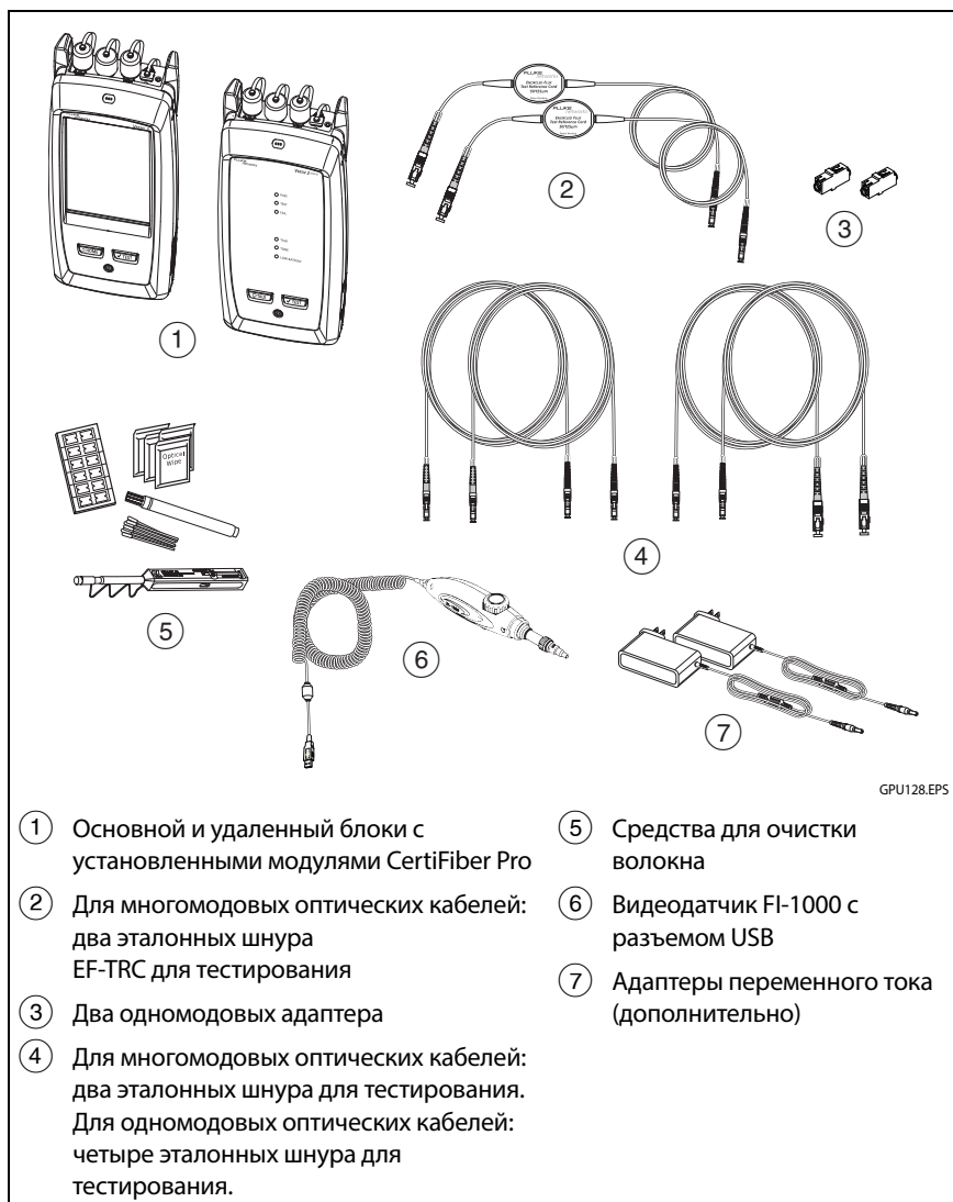
Рис. 50. Оборудование для выполнения автотестов в режиме Smart Remote
