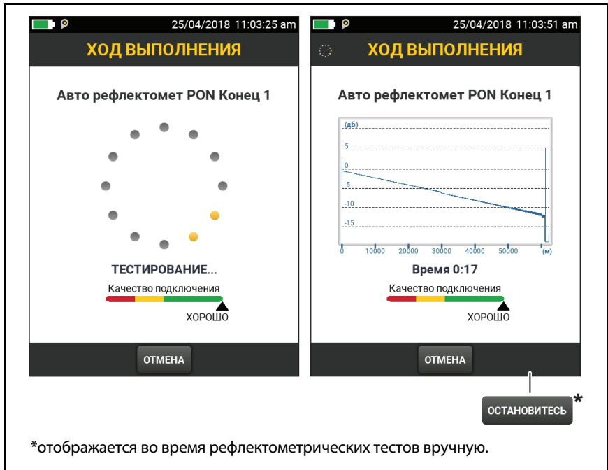
Рис. 88. Показатель качества соединения с портом рефлектометра и экран «Ход выполнения»
