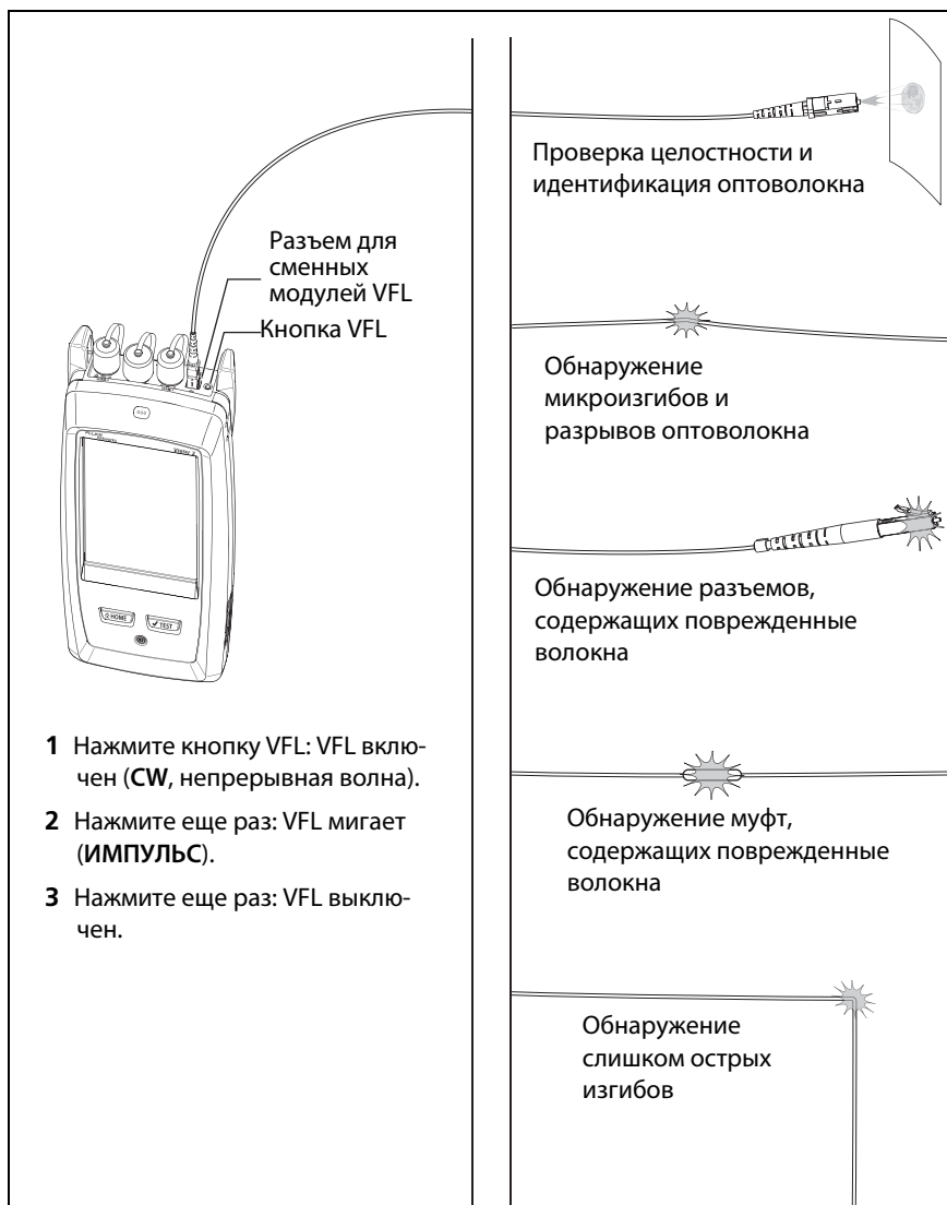
Рис. 110. Использование визуального локалятора повреждений
