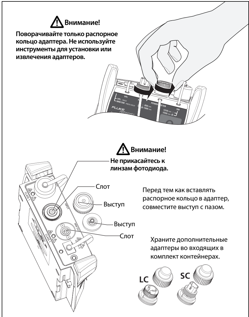
Рис. 44. Извлечение и установка адаптеров разъемов
