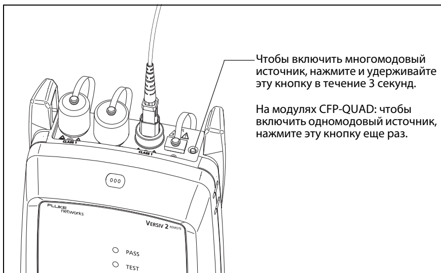
Рис. 57. Включение оптического источника на удаленном тестере
