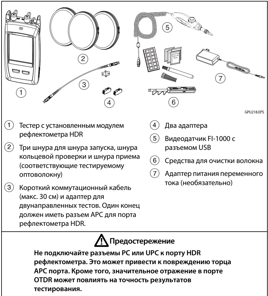
Рис. 99. Оборудование для выполнения теста SmartLoop
