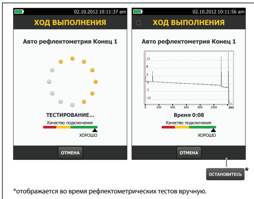
Рис. 66. Показатель качества соединения с портом рефлектометра и экран «Ход выполнения»
