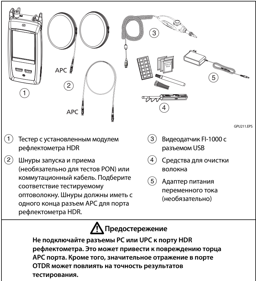
Рис. 89. Оборудование для выполнения рефлектометрических тестов HDR
