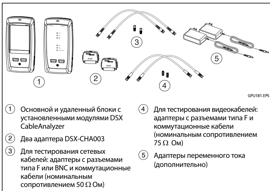
Рис. 29. Оборудование для тестирования коаксиальных кабелей
