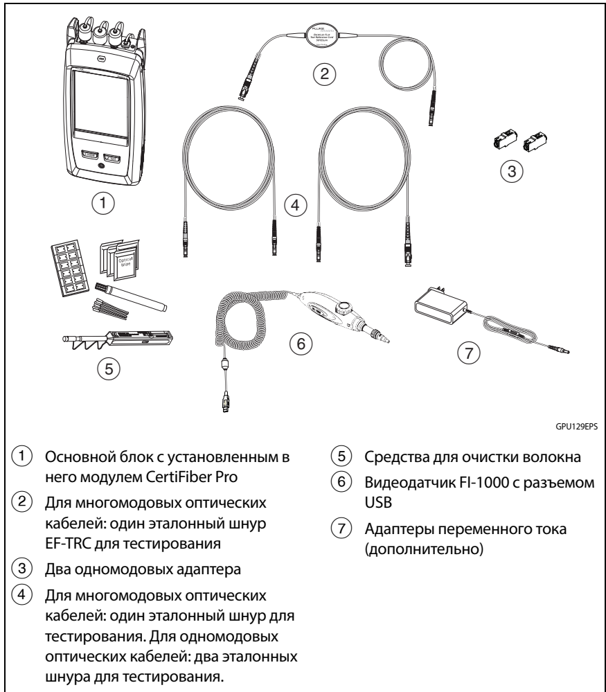
Рис. 53. Оборудование для выполнения автотеста в режиме кольцевой проверки
