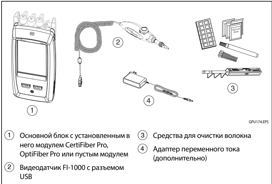
Рис. 37. Оборудование, необходимое для выполнения теста FiberInspector
