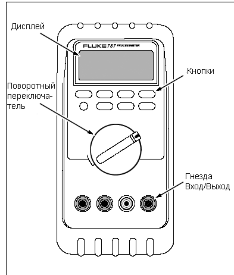
Рис. 1 Мультиметр-калибратор Fluke 787 ProcessMeter
