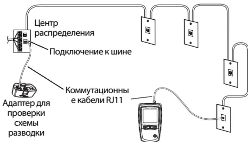
Примечание. Можно поменять местами расположение тестера и адаптера для проверки схемы разводки.
